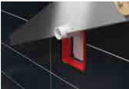
7. Lõigake keermestatud toru määratud kohast
