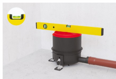
6. Ablaufkörper mit Ablaufleitung verbinden, Rohrgefälle über die Befestigungswinkel in der Höhe einstellen.
