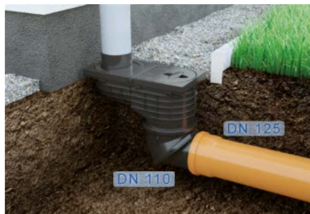
5. Kanalrohr anschließen DN110 - direkt DN125 - ablängen!
