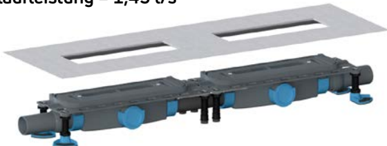
Ablaufgehäuse Duo HL53KF.2 Bauhöhe 65 mm Ablaufleistung = 0,86 l/s
