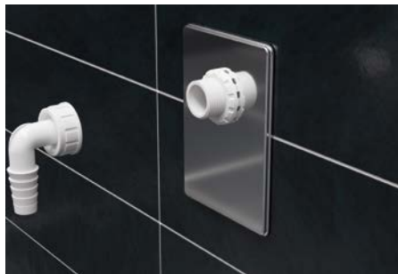
8. Edelstahlabdeckung aufsetzen und mittels Gewindinge befestigen, sowie Anschlussknie handfest auf den Gewindestutzen anschrauben.
