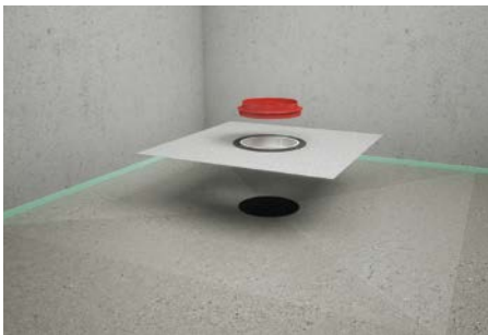
7. Dichtmanschette in den Ablauf einstecken, Bauschutz umdrehen und wieder einsetzen.
