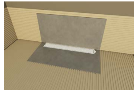
9. Fliesen bis an den Bauschutz verlegen
