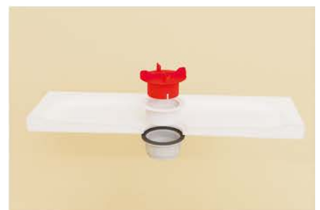
12. Ablaufventil in die Öffnung der Duschtasse einsetzen und mittels Montageschlüssel/Bauschutz mit der Gegenmutter so fest verschrauben, dass die Dichtung der Gegenmutter streng auf der Unterseite der Duschtasse sitzt (Dichtheit!!)
