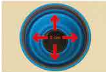
Yapı korumasını indirin, flex elementi her bir yöne 4 cm'lik (artı/eksi ortadan 2 cm) yanlışıkları gövde ile duş teknesi arasın'da dengeler.
