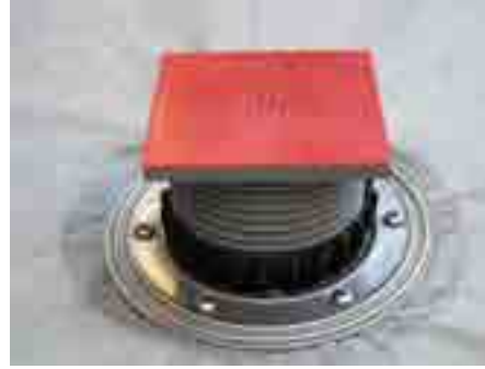
5. Geotextil filtre keçeyi paslanmaz çelik flanşın (HL83.0) ve yükseltme parçasının (HL85N) arasına sıkıştırın, su boşaltma halkasını (HL180) üzerine koyun, süzgeç başlığını koruyucu kapağı ile teras plakaların seviyesine getirin
