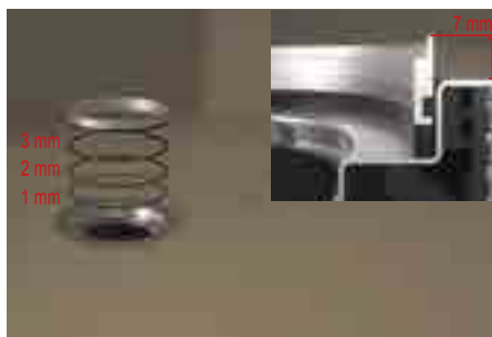
11. Der Edelstahlaufsatzring kann auch mit einem oder in Kombination mit mehreren Unterlegringen auf die erforderliche Beschichtungshöhe angepasst werden. Die Höhenanpassung erfolgt in 1 mm Schritten. Der Verstellbereich liegt hier zwischen 1 - 7 mm.
