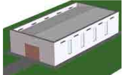
Slika 5: Ilustracija rješenja sekundarne odvodnje s pravokutnim otvorima
