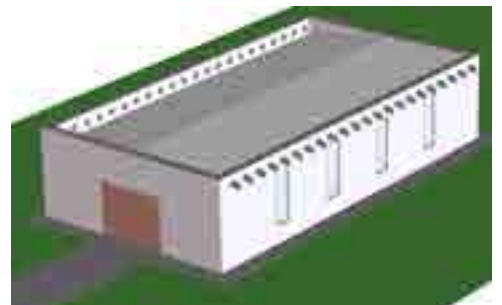
Slika 6: Ilustracija rješenja sekundarne odvodnje s okruglim preljevima (cijevima)
